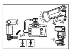
3) Tome un transceptor en la mano como transmisor y presione hasta el fondo el botón multifuncional, la cámara toma fotos y el flash dispara sincrónicamente.
